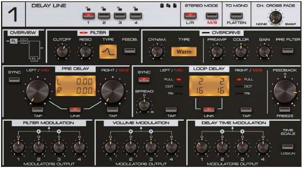
The Delay Line parameters
